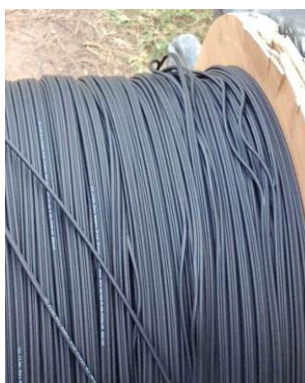
ภาพประกอบที่ 3.13 ต้นแบบสาย Armoured Round Type Version 1 และ 2 ซ้ำรูปลวดตัดออกนอกฉนวนห่อหุ้ม
