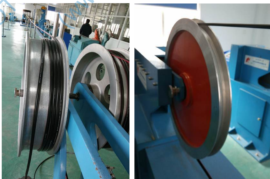
ภาพประกอบที่ 3.5 ทดสอบค่า Breaking Load สายเคเบิล ADSS OFC แนวนอน
