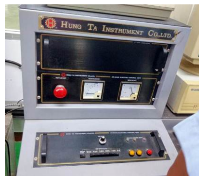
ภาพประกอบที่ 3.19 ทดสอบการรับแรงดึงสาย Support Strand 1 \times 1.2 \text{ mm} . และ 7 \times 0.4 \text{ mm} .
