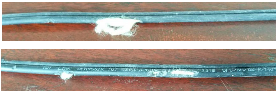
ภาพประกอบที่ 4.15 สาย Round Type ปกติที่ชำรุดเสียหายจากสัตว์กัดแทะ
