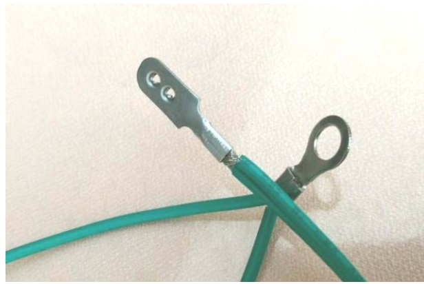
ภาพประกอบที่ 4.12 ขนาดสาย Ground ภายในหัวต่อเคเบิลสาย ARSS OFC
